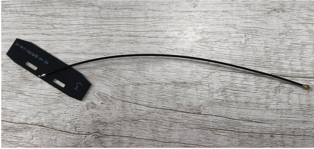
HS-五代 PRO-3#-2.4G 全向天线 PCB 黑色 To IPEX 一代 OD1.37mm 黑色低损线 L185mm
