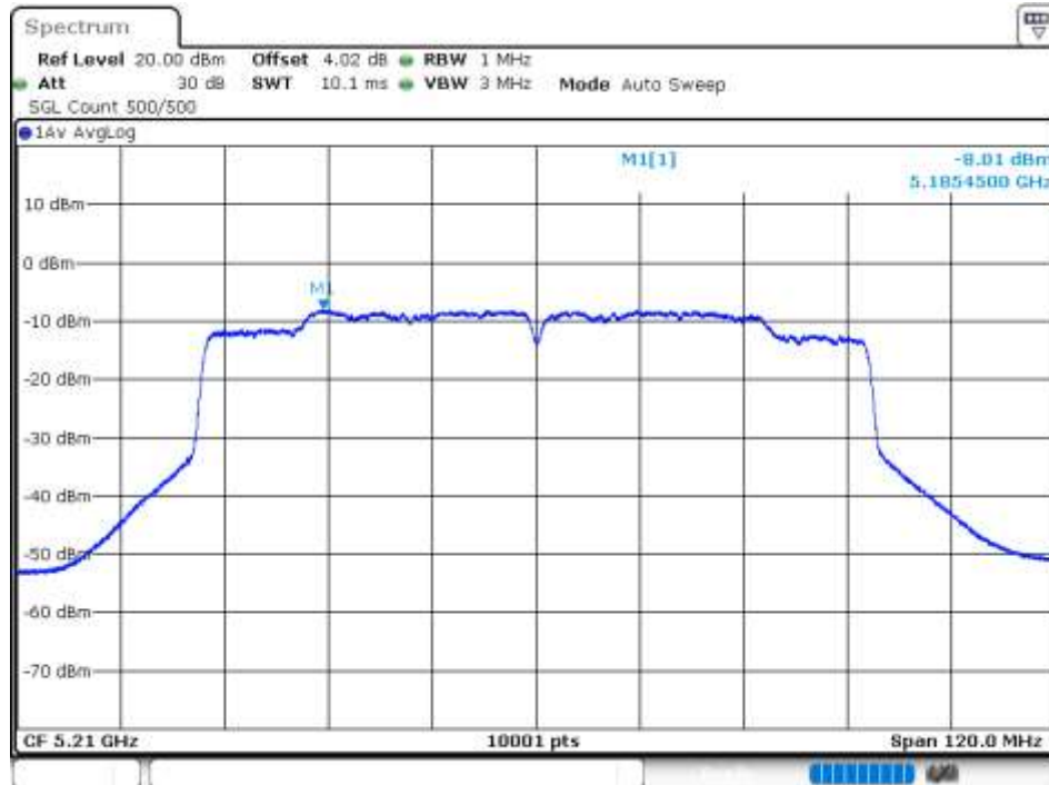
PSD NVNT ax80 5210MHz Ant1
