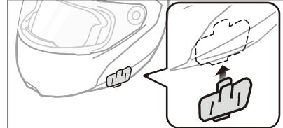
3) 把主机对准底座卡槽从上往下推，听到卡扣响声即安装成功。
