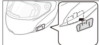
2.2) 夹式卡扣安装，找准头盔左侧边缘安装位置夹住，然后用力推到头盔左侧合适的位置。
