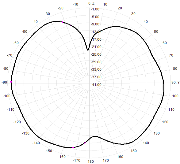
924.0MHz Total(E2-YZ), Max= -2.81dBi
