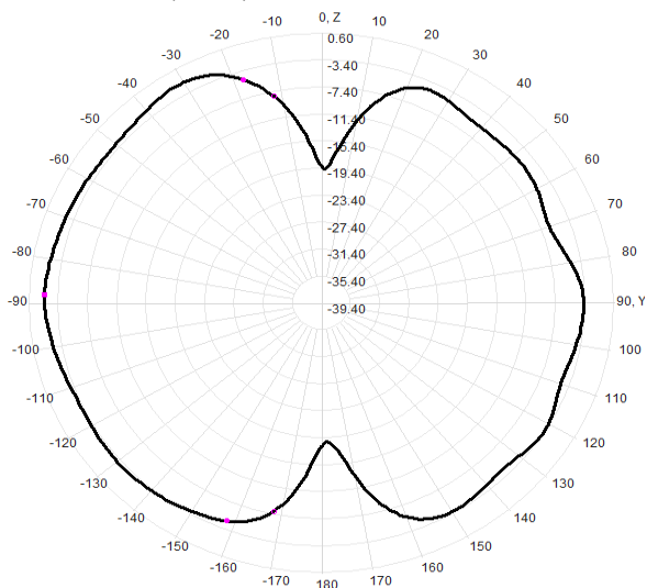
906.0MHz Total(E2-YZ), Max= -1.56dBi
