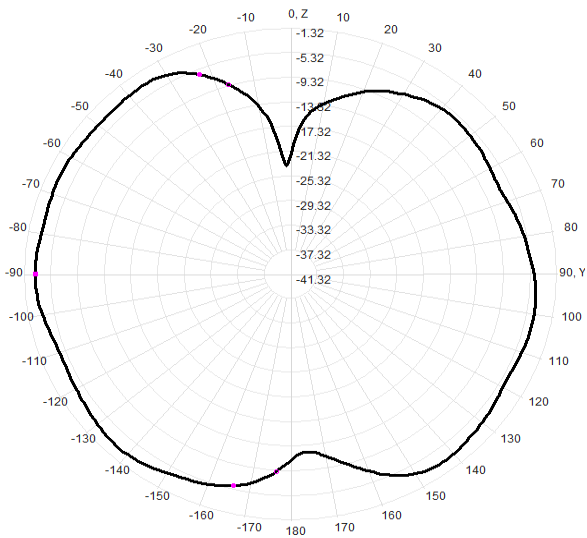
927.0MHz Total(E2-YZ), Max= -2.95dBi
