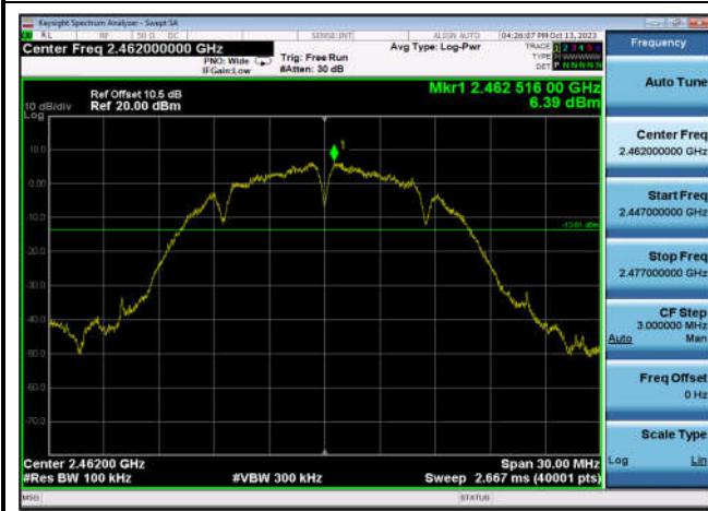
,Plot 2,Band Edge-802.11b,2437MHz ,Ant0
