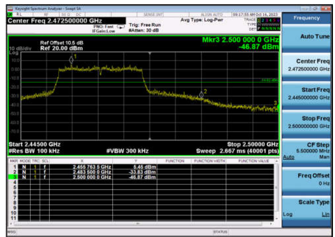
,Plot 2,Band Edge-802.11n(HT20) ,2462MHz,Ant0
