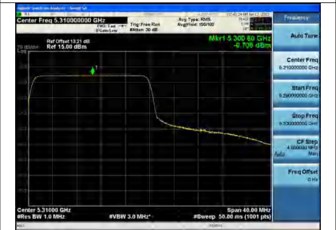
Test Mode:802.11be EHT40 5310MHz Chain1
