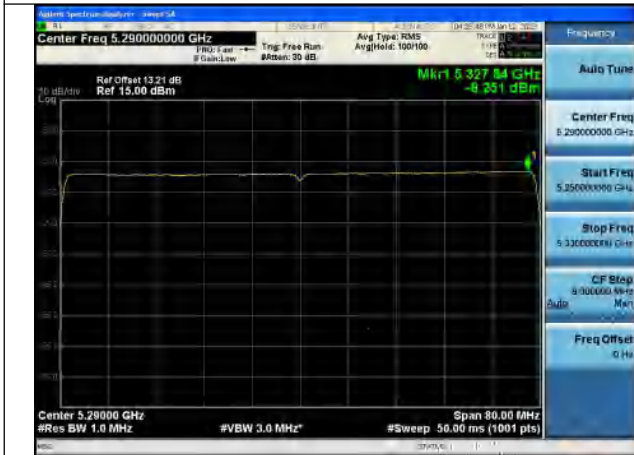
Test Mode:802.11be EHT80 5290MHz Chain0
