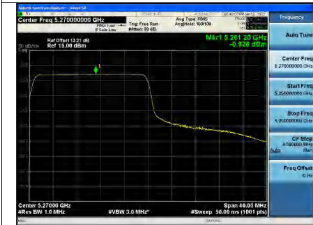
Test Mode:802.11be EHT40 5270MHz Chain1
