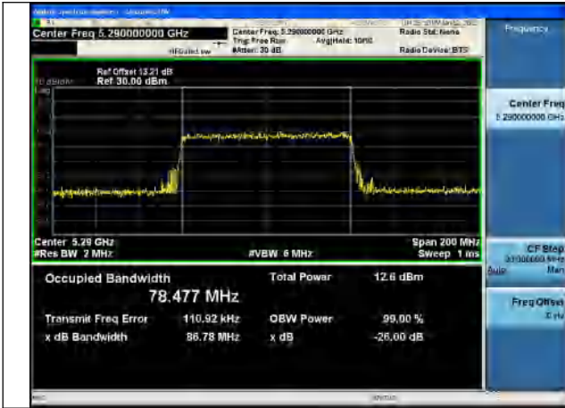
Test Mode:802.11be EHT80 5290MHz Chain0
