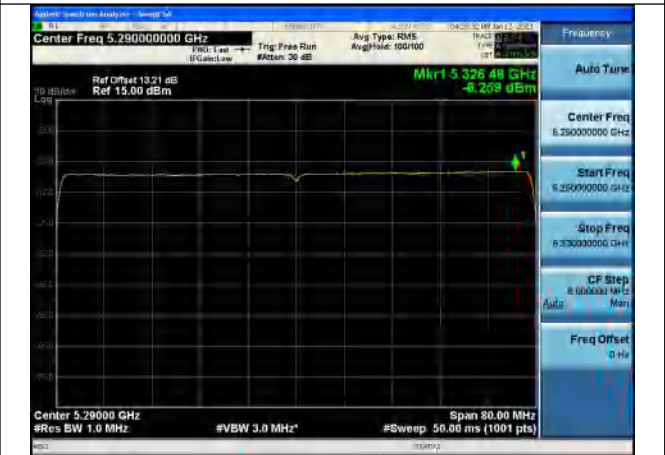
Test Mode:802.11be EHT80 5290MHz Chain1
