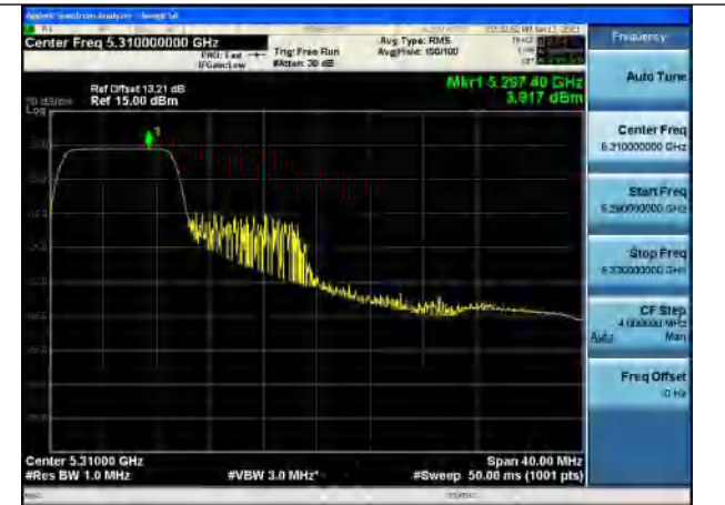
Test Mode:802.11be EHT40 5310MHz Chain1
