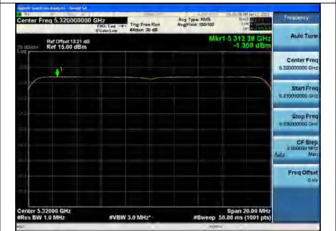
Test Mode:802.11be EHT20 5320MHz Chain1
