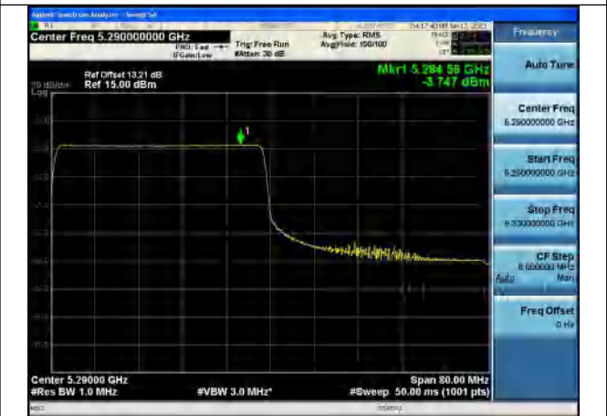
Test Mode:802.11be EHT80 5290MHz Chain1
