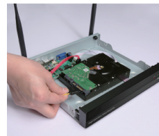
4. Conecte el cable de alimentación
