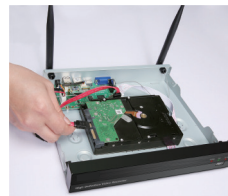
3. Conecte el cable de datos
