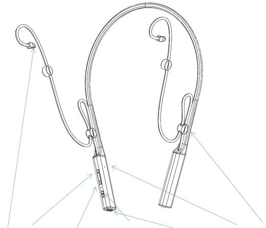
音量键"+"键 音量键"-"键 功能键"O" type-c 插口与指示灯 麦克风 束线器 0.78MM 插头 Volume+, volume-, function button "o",Type-C port and indicator, Microphone, buncher, 0.78mm 2Pin jack
