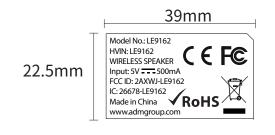
贴纸:39\*22.5mm,铜版纸, 白底黑字印刷,表面过哑油
