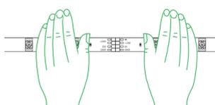
**6** Pour la configuration des coins, pliez la bande et renforcez-la à l'aide de clips; (Remarque: évitez de vous pencher sur les perles LED.)
