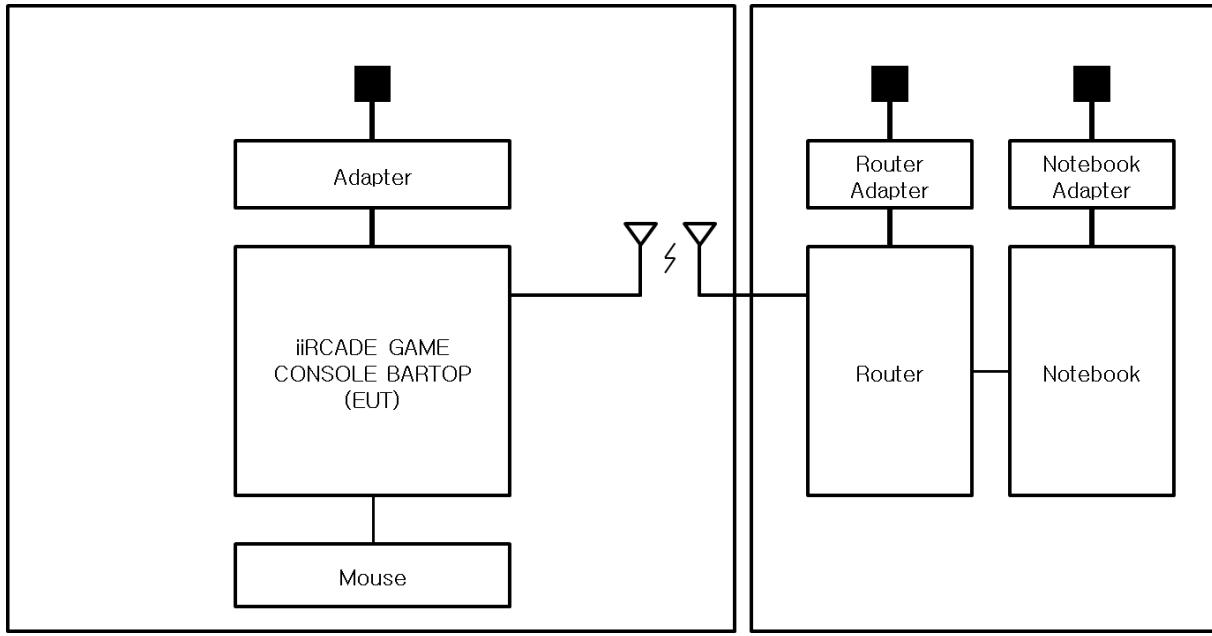
EUT - Router : WLAN 2.4 GHz Band
