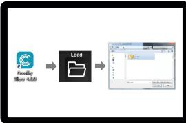
4.Open Creality 3D slicer → Load (Read file) → Select file. 打开创想三维切片软件→Load (读取文件) →选择文件。
