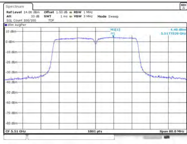
UNII-2C / 802.11ac VHT40 / 5 590 MHz
