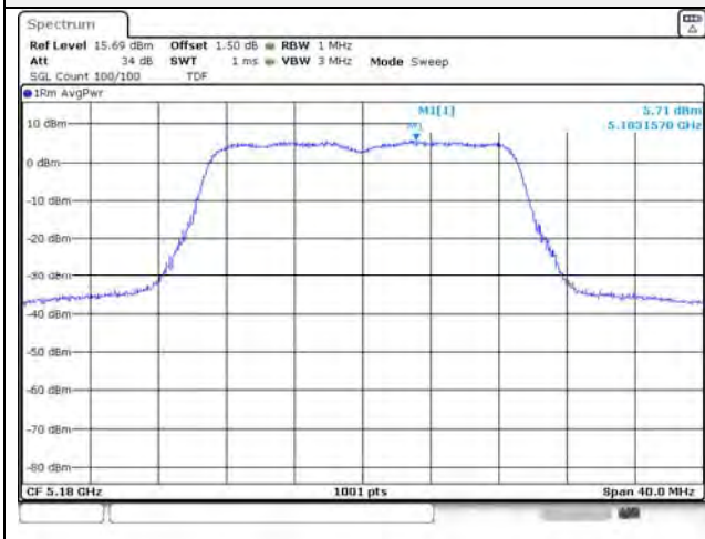
UNII-1 / 802.11ac VHT20 / 5 220 MHz
