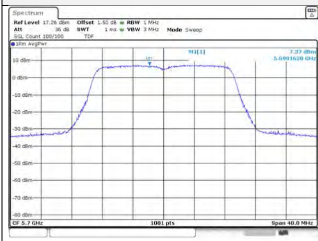
UNII-2C / 802.11ac VHT20 / 5 700 MHz
