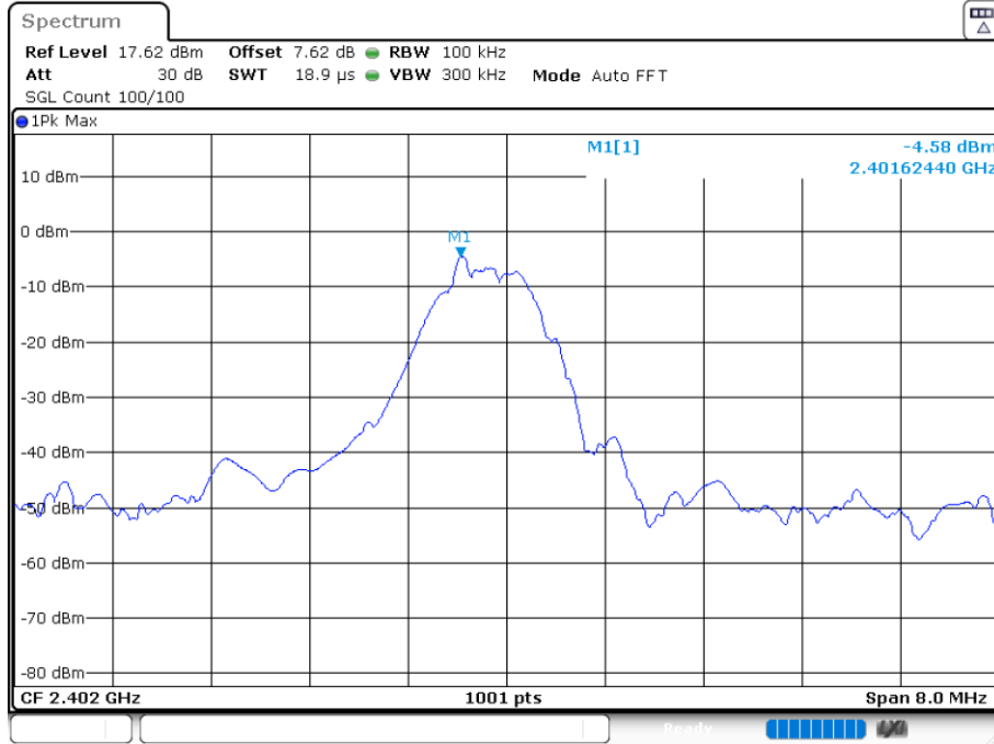
Band Edge NVNT BLE 2402MHz Ant1 Ref
