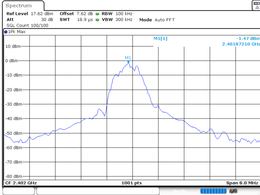
Band Edge NVNT BLE 2402MHz Ant1 Ref
