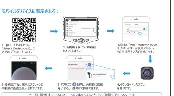
ンコードを入力することで、アプリに出てきた広告を非表示にできます。 商品仕様 レンズ直径 6.2mm 8.5mm ケ**ー**ブル長さ 1.55m 1.55m ケーブル材質 フレキシブル金属 フレキシブル金属 視野角 80° カメラ 焦点距離 15-100mm 15-100mm 光源 4つLEDライト 8つLEDライト センサー 1/9 CMOS 1/5 CMOS 可動角度 最大210° 最大210° サイズ 5インチ 明るさ調整 可能 (ッテリー 3000mAhリチウムイオン電池 モニター 動作時間 約3.5時間 対応 8種類対応
