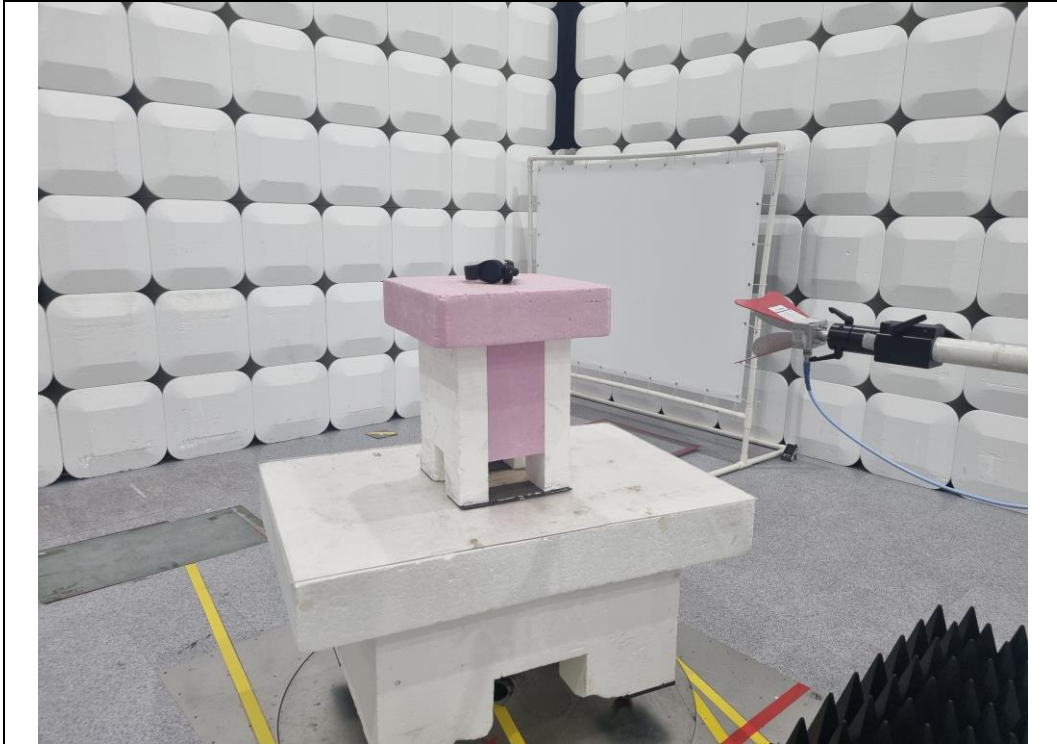
Test distance : 1 m, height of table : 1.5 m
