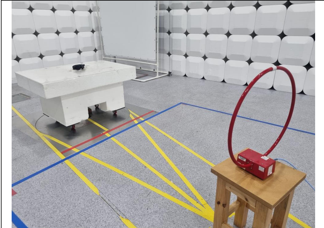
Test distance : 3 m, height of table : 0.8 m
