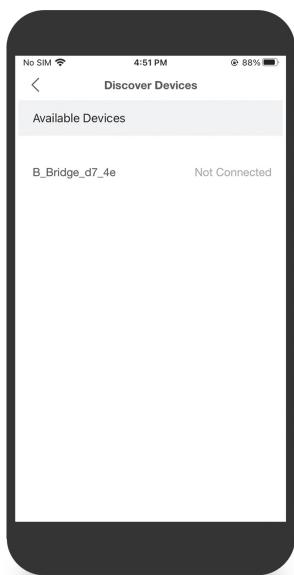
Sélectionnez l'adaptateur dans l'écran “Discover” (Découverte), l'appareil mobile vous demandera un code à 6 chiffres. Saisissez les six derniers chiffres du numéro de série de votre adaptateur, lesquels se trouvent sur l'étiquette avant de l'adaptateur. Cette étape sert à l'authentification multifacteur et à des fins de sécurité.
