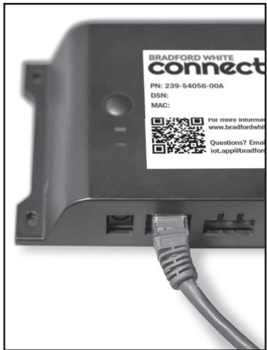
**2.** Branchez une extrémité du câble Ethernet dans le port RJ45 de l'adaptateur et l'autre dans le port RJ45 du chauffe-eau. Un câble Ethernet CAT5e de 2,13 m (7 pi) est fourni avec l'adaptateur Bradford White Connect<sup>MC</sup>. Veuillez utiliser ce cable ou un câble similaire, jusqu'à une longueur maxi de 30,48 m (100 pi).
