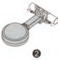
1. Fixe a placa de montagem à coluna horizontal, inserindo duas braçadeiras através da placa de montagem.
