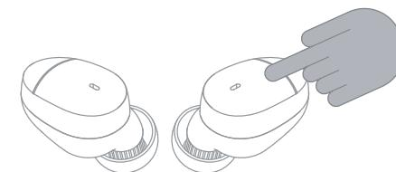
触控感知面板持续触碰维持约3秒后，电源将会随着2种电子音效的响起而被关闭。
