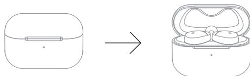
充电后将充电盒的盖子打开，耳机本体电源会自动开启。耳机启动后耳机上的红色LED指示灯将持续约3秒。(在耳机充满电的情况下，耳机的绿色LED指示灯会亮约1秒后变成红灯并维持约3秒。)充电盒的LED指示灯显示方式会随电池的电量如下表显示。
