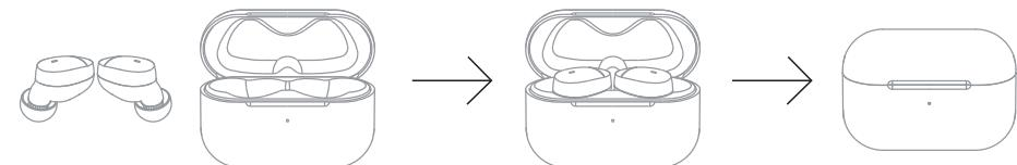
充电盒的电池残量足够的情况下，将耳机本体放回到充电盒中并阖上盖子，电源就会自动被关上并开始进行充电。充电盒的LED指示灯显示方式会随电池的电量如下表显示。
