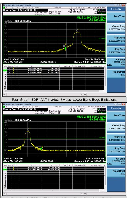
Test\_Graph\_EDR\_ANT1\_2480\_3Mbps\_Higher Band Edge Emissions
