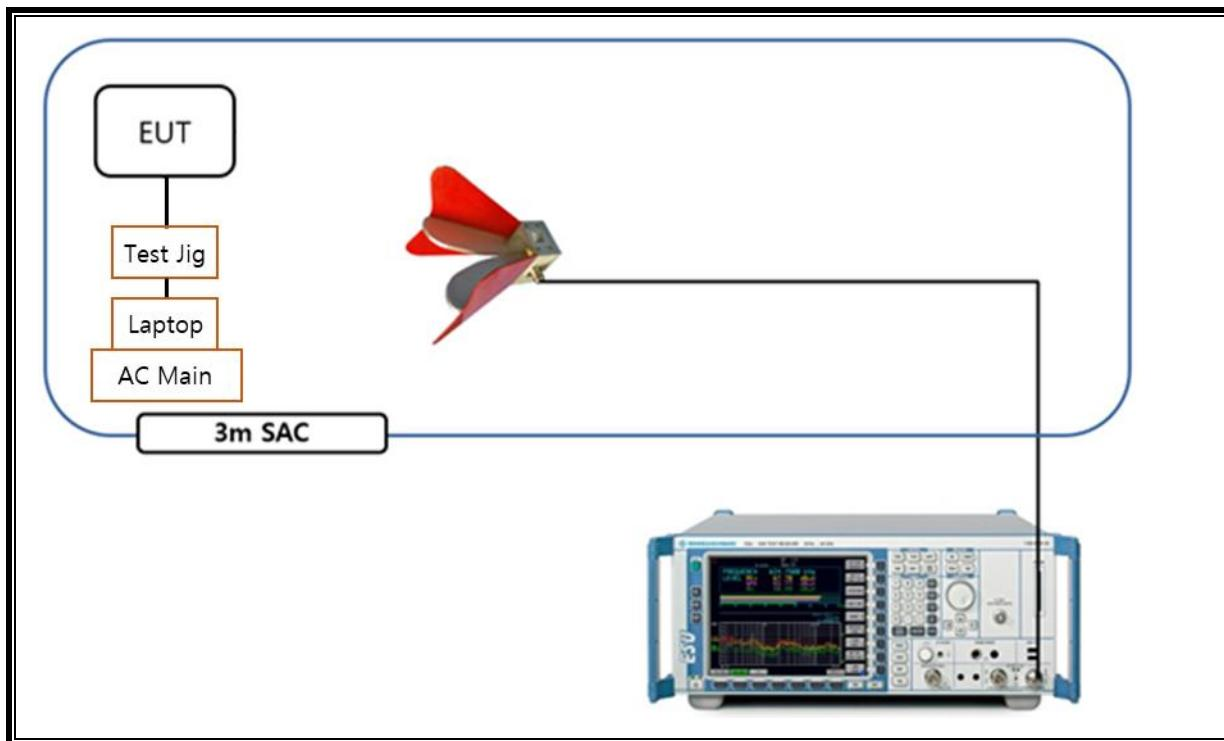
**SETUP DIAGRAM FOR TESTS (AC POWER LINE TEST SETUP)**
