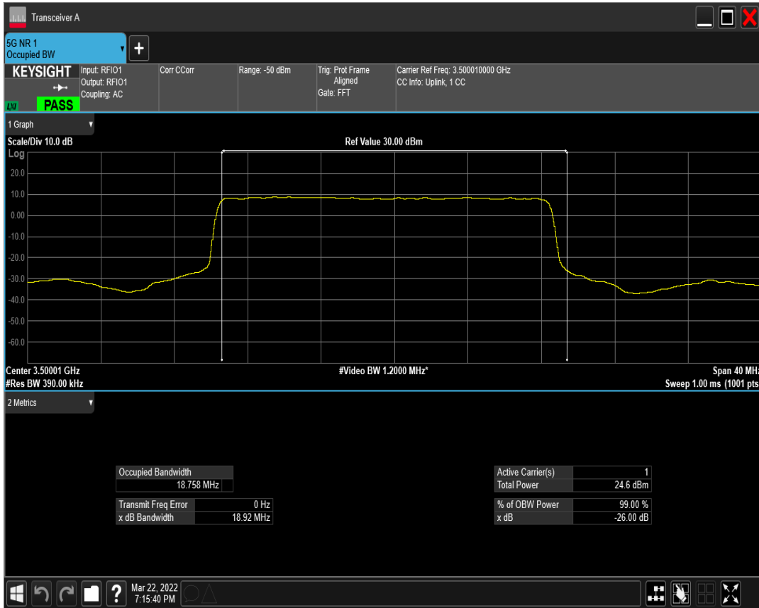
n77(3450-3550) SCS=15kHz DFT_QPSK BW=20MHz Channel=633334 RB=100@0
