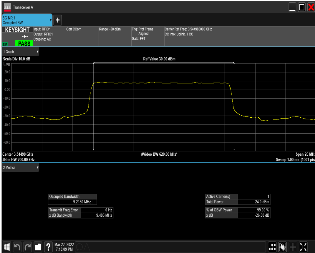
n77(3450-3550) SCS=15kHz DFT_QPSK BW=10MHz Channel=636332 RB=50@0
