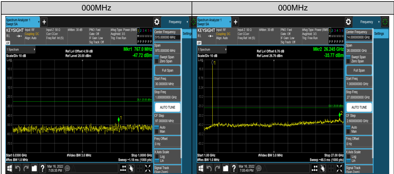
Band7-20MHz-QPSK-20850-1RB#0-Range1:30~1 000MHz Band7-20MHz-QPSK-20850-1RB#0-Range2:1000~27 000MHz
