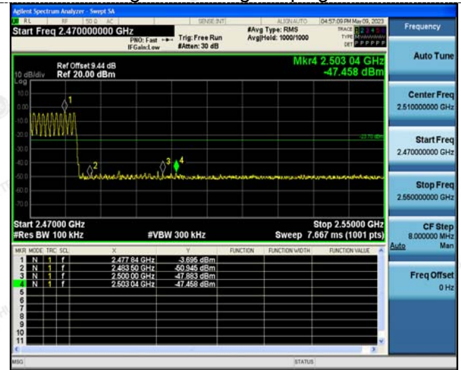
Right Band edge hopping on
