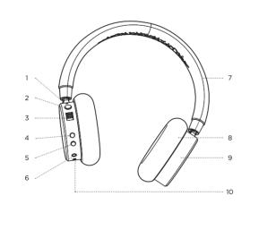
1. Indicador LED 2. Botón de B**l**uetooth encendido / apagado 4. Vol +
