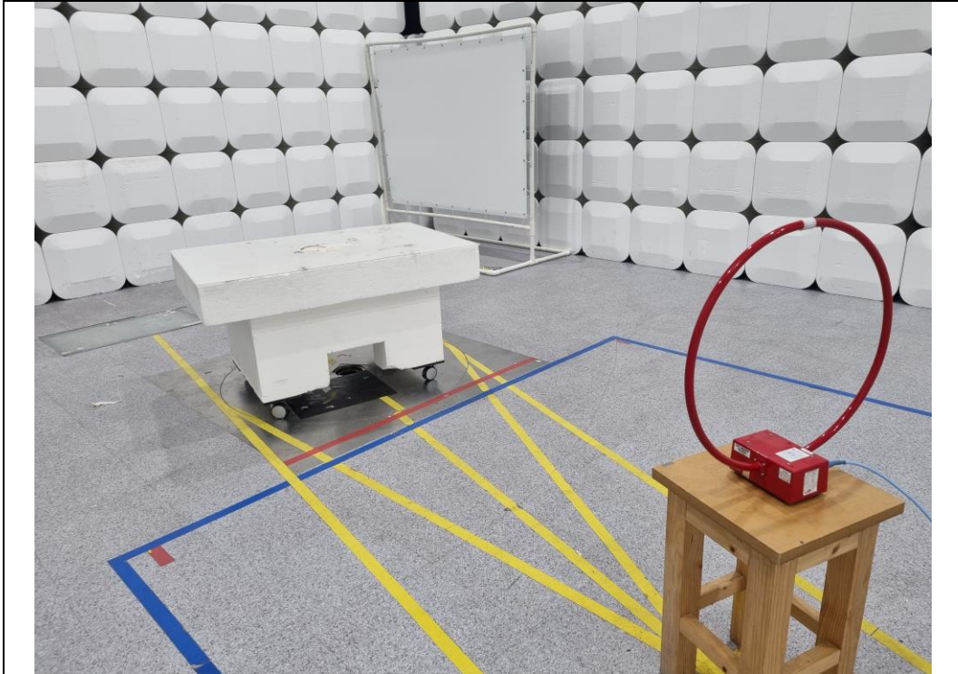
Test distance : 3 m, height of table : 0.8 m
