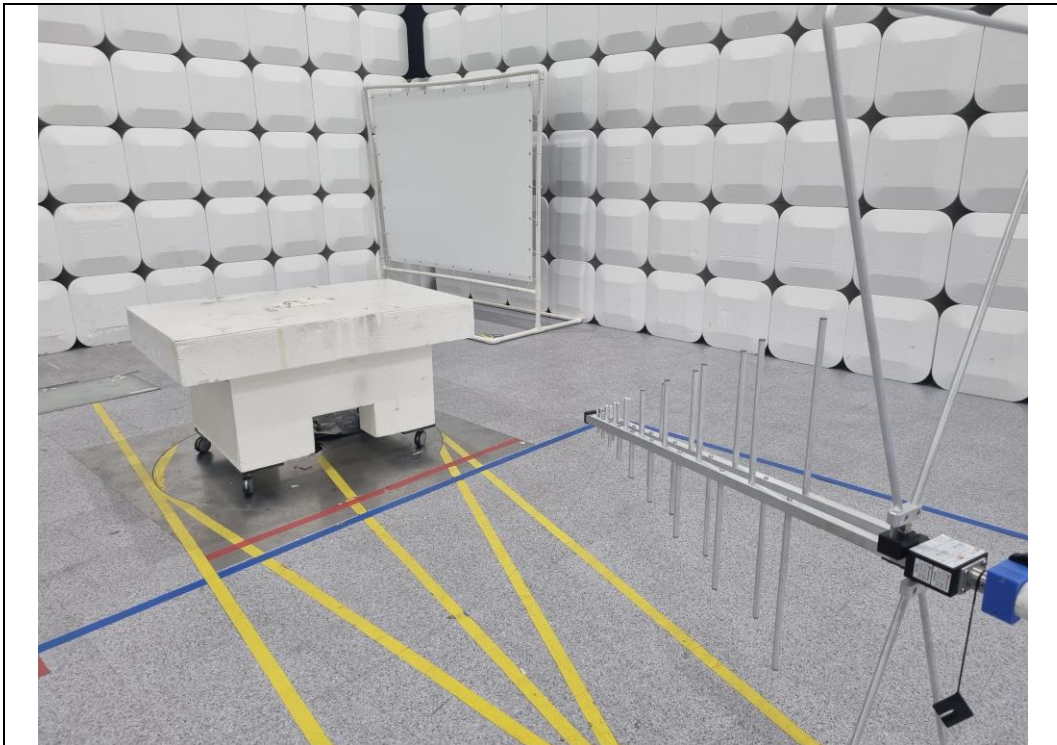
Test distance : 3 m, height of table : 0.8 m
