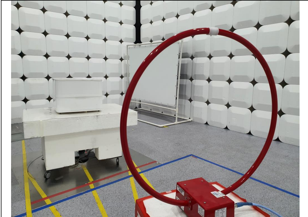
Test distance : 3 m, height of table : 0.8 m
