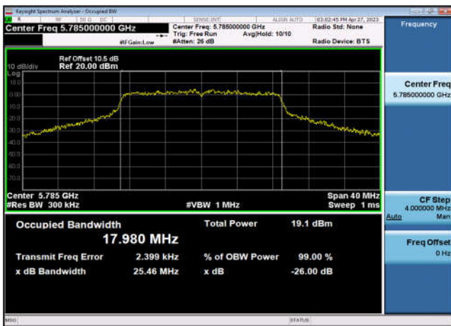
U-NII-3 26dB&99% Bandwidth-802.11ac(40MHz) ,5755MHz,Ant1
