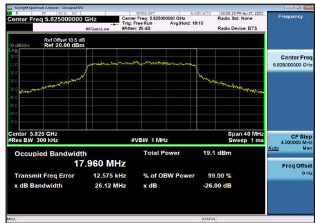
U-NII-3 26dB&99% Bandwidth-802.11ac(40MHz) ,5795MHz,Ant1
