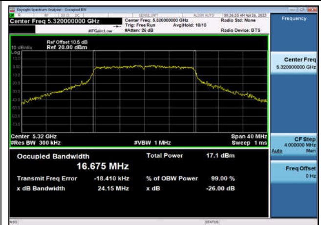
U-NII-2a 26dB&99% Bandwidth-802.11ac(20MHz) ,5300MHz,Ant1
