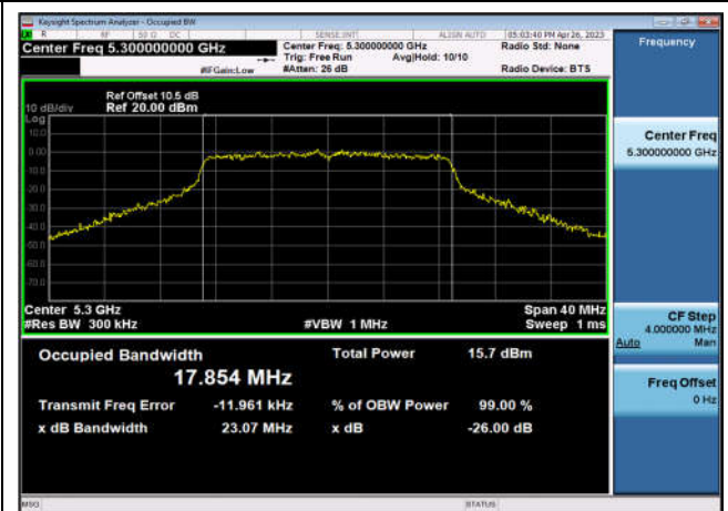
U-NII-2a 26dB&99% Bandwidth-802.11ac(20MHz) ,5300MHz,Ant1
