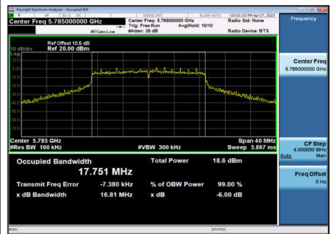
U-NII-3 6dB Bandwidth-802.11ac(40MHz) ,5755MHz,Ant1
