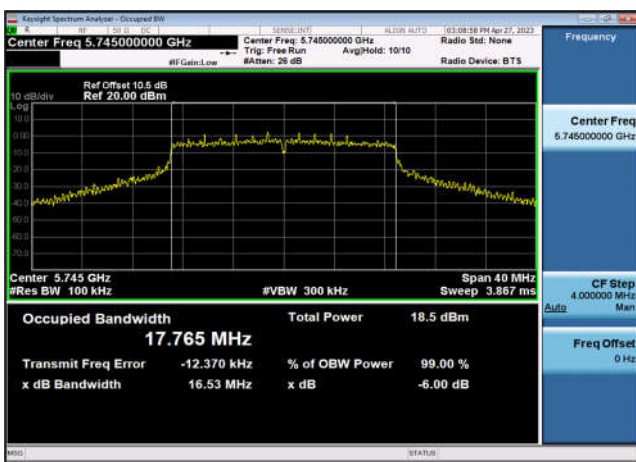
U-NII-3 6dB Bandwidth-802.11ac(20MHz) ,5825MHz,Ant1
