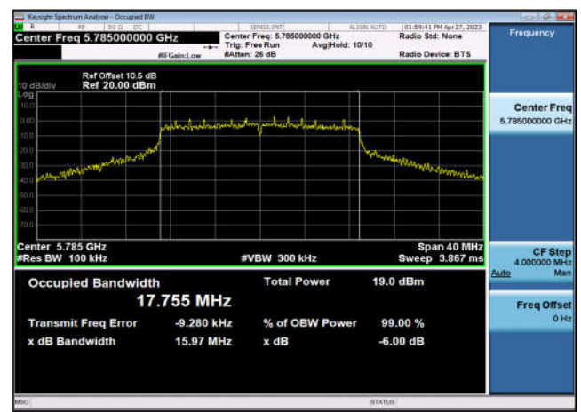
U-NII-3 6dB Bandwidth-802.11n(40MHz) ,5755MHz,Ant1
