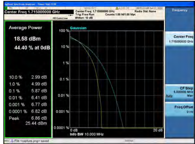
B4 / 10MHz / Mid CH / 16QAM
