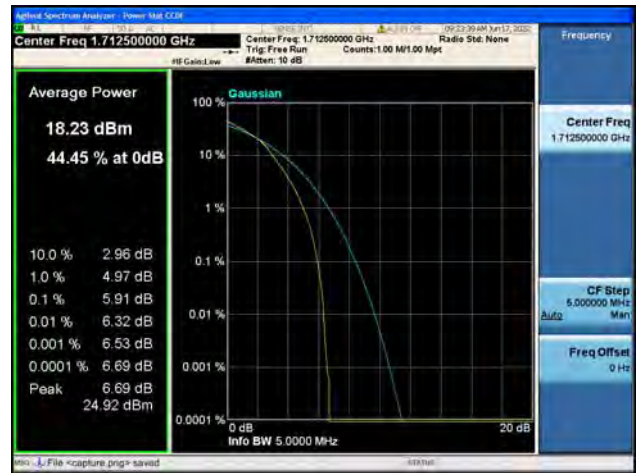
B66 / 5MHz / Mid CH / 16QAM
