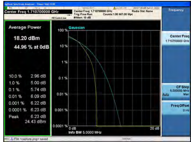
B66 / 1.4MHz / Mid CH / 16QAM
