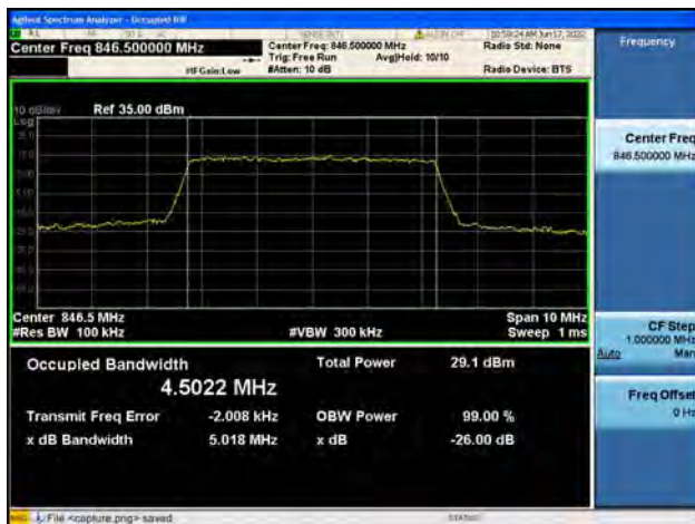
B5 / 5MHz / QPSK/ High CH
