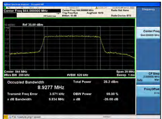
B5 / 10MHz / 16QAM/ High CH
