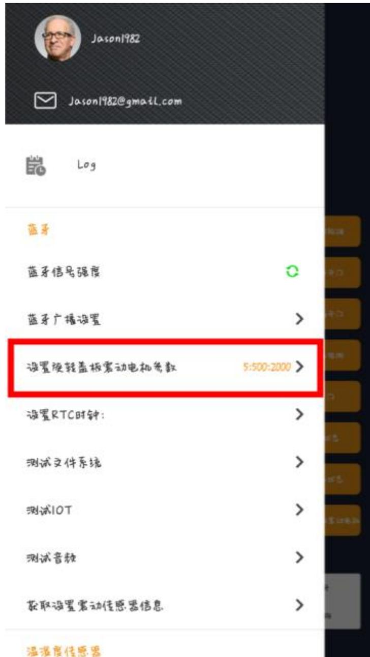
如上图所示，设置参数的格式为：震动次数;检测时间;振动时间，振动时间的单位为毫秒。
