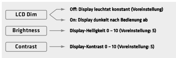
**LCD Dim:** Ist die Funktion deaktiviert (Off), bleibt das Display in konstanter Helligkeit. Ist die Funktion aktiviert (On), dunkelt sich das Display acht Sekunden nach der letzten Bedienung des Master-Reglers ab, bleibt aber weiterhin gut lesbar. Sobald der Master-Regler bedient wird, leuchtet das Display wieder in der eingestellten Helligkeit.
