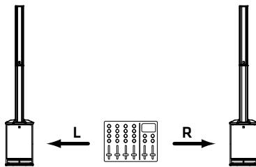
Kommen zwei POLAR 10 MK2 oder Polar 12 MK2 als Stereosystem zum Einsatz, erhält das linke System das linke Mischpultsignal, das rechte System das rechte. In dieser Betriebsart sollten Sie darauf achten, dass die DSP-Klangeinstellungen (Mode, EQ, Delay etc.) bei den beiden Systemen identisch sind, siehe Kapitel 3.
