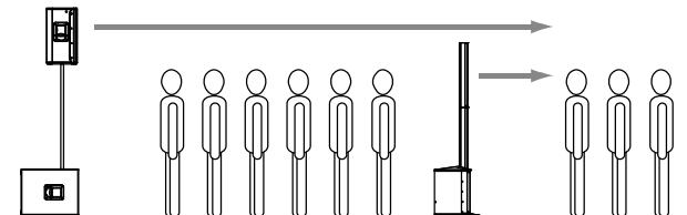
Dank der integrierten Delay-Funktion kann POLAR als Stützlautsprecher (Delay-Line) eingesetzt werden, siehe Kapitel 3.2 "Delay". Ermitteln Sie die Distanz zwischen Hauptlautsprecher und POLAR und geben Sie den Wert in Metern über den Punkt "Delay" im DSP-Menü ein. POLAR übernimmt automatisch die Umrechnung zur Laufzeit-Kompensation und verzögert die Tonausgabe passend zur Schall-Laufzeit des Hauptlautsprechers.
