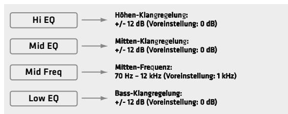
POLAR bietet eine 3-Band-Klangregelung, um den Gesamtklang des Systems anzupassen. Hi-EQ und Low-EQ sind als Shelving-Filter ausgeführt, der Mid-EQ ist semiparametrisch.
