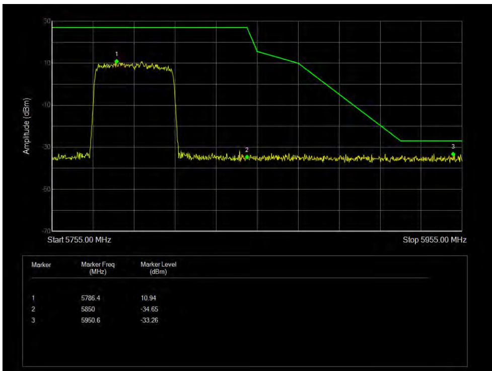
Band Edge NVNT 802.11ax40 5795MHz High Ant 1
