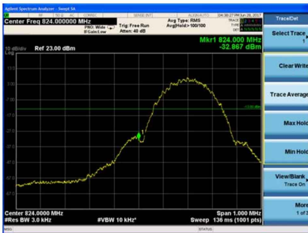
LTE Band 5 QPSK 1.4MHz CH-Low 1RB
