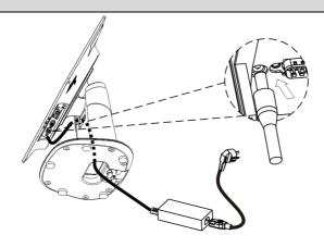
适配器电源插头穿过支架底部过线孔,然后将电源插头插入主板接口,再接
