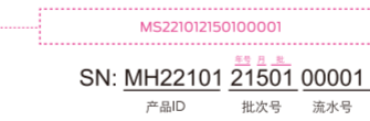
镭雕信息 尺寸:17x1.8mm 颜色:镭雕本色 字体:Antenna Regular 字号:4.6 pt 比例1:1
