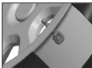
F、将阀杆放入阀孔中,借助套筒扳手用4N·m拧紧螺母,并用3N·m拧紧螺丝钉
