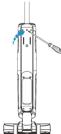
Si le produit doit être retourné, démontez la poignée. Appuyez sur le ressort pour libérer la poignée à l'aide d'un outil (par exemple un tournevis) et soulevez la poignée de l'appareil.
