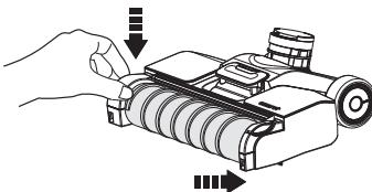
Para volver a colocar el cepillo de rodillo, inserte el extremo del cepillo de rodillo en el lado derecho del soporte y, a continuación, bloquee la pestaña de extracción en su sitio presionando hacia abajo.
