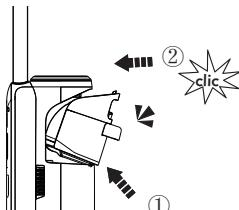
Replacez le réservoir dans l'appareil. Vous entendrez un « clic » lorsque le réservoir est bien en place.
