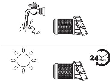
Le filtre HEPA peut être lavé à l'eau courante et doit être séché complètement avant d'être réinstallé.
