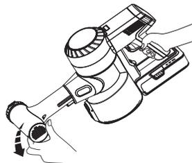
Utilisez l'appareil en mode MAX et faites pivoter le capot latéral pour nettoyer le pré-filtre encrassé.
