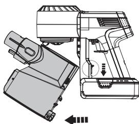
Pour nettoyer plus en profondeur le bac à poussières, appuyez sur son bouton de déverrouillage pour le détacher de l'appareil.
