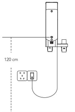
Déterminez le meilleur emplacement pour fixer la station d'accueil au mur. Nous recommandons de le placer à 120 cm de la fixation inférieure au sol (il peut être nécessaire de l'ajuster en fonction de la situation réelle).
