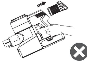
Ne placez pas l'appareil dans le sens indiqué ci-dessus lors du retrait ou de l'installation du filtre HEPA pour éviter que la poussière ne pénètre dans le conduit d'air du moteur.
