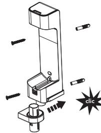
Assemblez les deux composants du support, jusqu'à entendre le « clic » indiquant un montage correct. Une fois cette étape terminée, utilisez les vis fournies par Tineco pour fixer la station d'accueil au mur.
