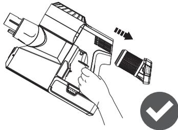
Appuyez sur le bouton de déverrouillage HEPA et retirez-le délicatement pour le nettoyage. N'utilisez pas l'appareil sans avoir préalablement installé le filtre HEPA.
