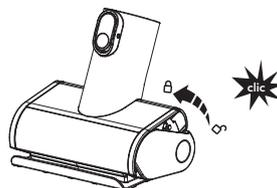
Réinsérez complètement le rouleau brosse en l'inclinant et poussez-le vers le haut jusqu'à ce qu'il se remette fermement en place avec un clic.
