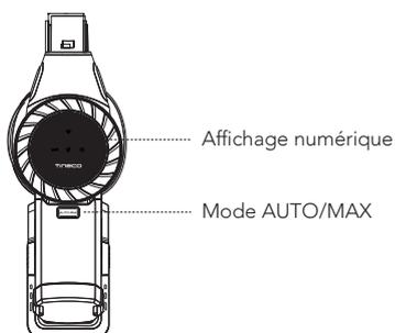
L'appareil démarre en mode AUTO par défaut. Après 3 secondes, appuyez sur le bouton AUTO/MAX pour passer en mode Max. Le bouton s'allume.
