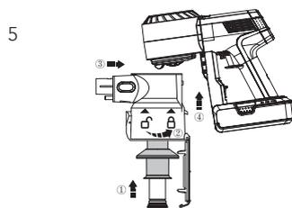
Après le nettoyage, insérez correctement le pré-filtre propre dans le filtre à mailles et il s'enclenche en place. Installez le filtre propre et le bac à poussière dans le corps principal, puis remplacez le couvercle du bac à poussières.
