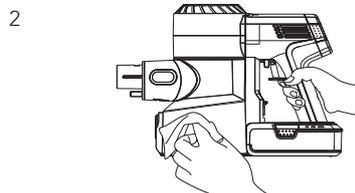
Nettoyez avec un chiffon humide, en prenant soin d'empêcher l'eau de pénétrer dans le corps principal et la batterie de l'appareil.
