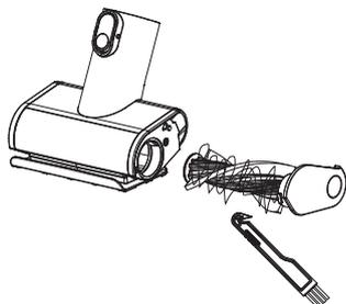
Enlevez les débris enroulés autour du rouleau avec l'outil de nettoyage des poils/cheveux Tineco.
