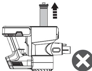
Ne retournez pas l'appareil lors du retrait ou de l'installation du filtre pour éviter que la poussière ne pénètre dans le conduit d'air du moteur.
