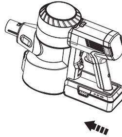
Pour la remettre en place, faites glisser la batterie dans l'emplacement au bas du boîtier principal. La batterie s'enclenchera en position une fois qu'elle sera correctement insérée.
