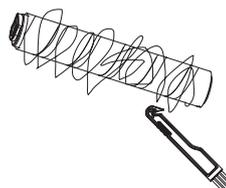
Enlevez les débris enroulés autour du rouleau avec l'outil de nettoyage des poils/cheveux Tineco.
