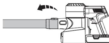
Appuyez sur le bouton de déverrouillage et retirez le tube.
