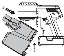
Lors de la réinstallation du bac à poussières, maintenez une certaine inclinaison et insérez le haut du bac à poussières dans le crochet du corps principal. Poussez vers le haut jusqu'à ce que le crochet soit fixé dans la fente du bac à poussières avant de s'enclencher en place.
