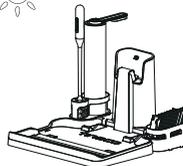
À l'aide de l'outil de nettoyage, retirez les cheveux et les débris enroulés autour du rouleau et rincez-le à l'eau. Remplacez le rouleau brosse dans le porte-accessoires et laissez-le sécher complètement avant de le réinstaller.
