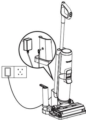
Pour charger l'appareil, placez-le sur la base de recharge et branchez l'adaptateur sur une prise secteur.
