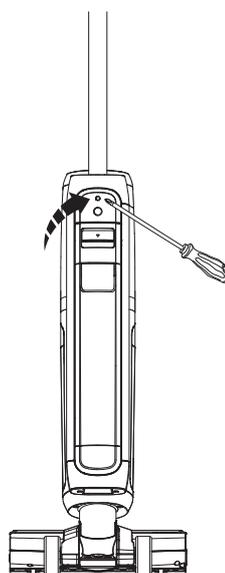
Si le produit doit être retourné, démontez la poignée. Appuyez sur le ressort pour libérer la poignée à l'aide d'un outil (par exemple un tournevis) et soulevez la poignée de l'appareil.
