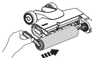
Remettez le rouleau brosse en place en insérant l'extrémité du rouleau dans le côté droit du support, puis fixez la languette du rouleau à la boucle magnétique à gauche pour la verrouiller en place.
