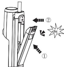
Remplacez le réservoir dans l'appareil. Vous entendrez un « clic » lorsque le réservoir est bien en place.
