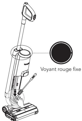
Lorsque la boucle LED est rouge, retirez le réservoir d'eau sale et nettoyez le capteur de saleté à l'aide d'un chiffon humide ou de l'outil de nettoyage.
