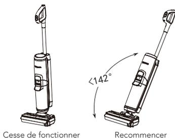
L'appareil s'arrêtera de fonctionner en position verticale et recommencera à fonctionner lorsque vous l'inclinerez.
