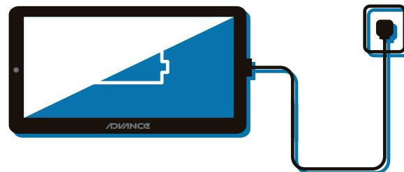
Para obtener el mejor rendimiento de tu batería, te recomendamos que la primera carga sea de 8 horas, luego realiza ciclos de carga de aproximadamente 5 horas, hasta completar el 100%.
