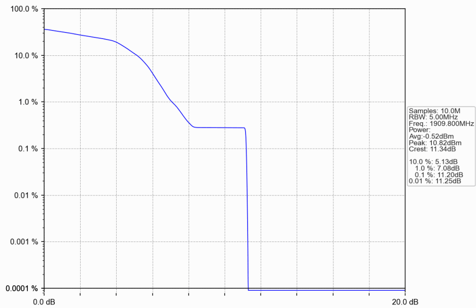
PCS1900_EGPRS_HCH_1909.8MHz_4 TX Slots_NTNV
