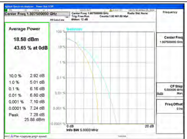
B2 / 5MHz / High CH / 16QAM
