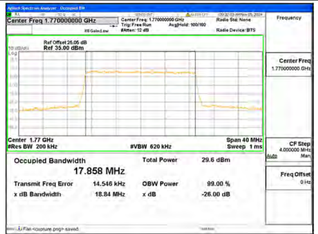
B66 / 20MHz / QPSK/ High CH
