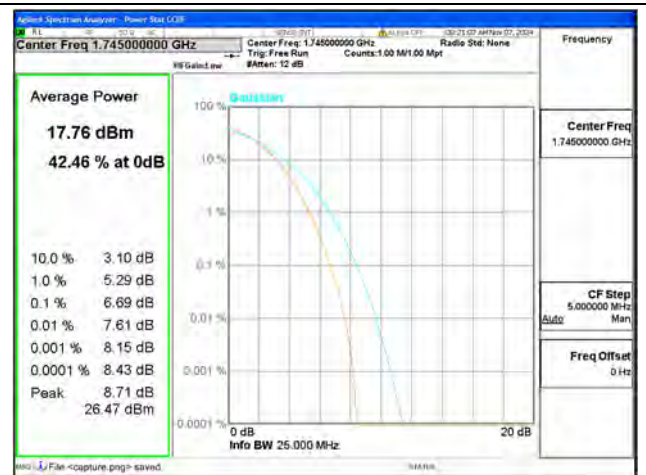
B4 / 20MHz / High CH / 64QAM
