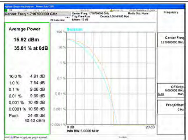
B4 / 1.4MHz / Low CH / 16QAM
