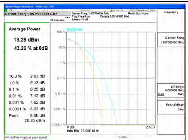
B2 / 15MHz / Low CH / 16QAM
