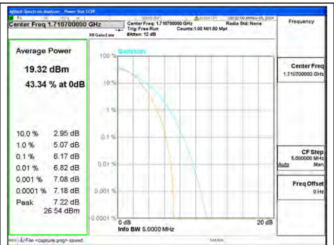
B66 / 1.4MHz / Low CH / 16QAM
