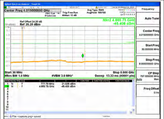
B13 / 10MHz / Mid CH / QPSK
