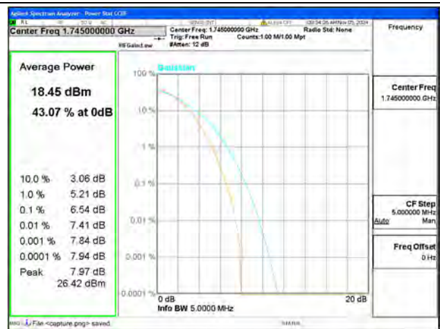
B66 / 5MHz / Mid CH / 64QAM
