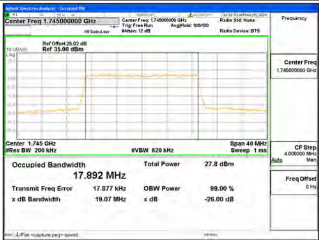
B66 / 20MHz / 64QAM/ Mid CH
