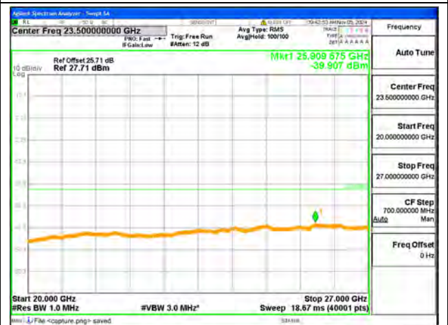
B38-20G-27G / 20MHz / High CH / QPSK
