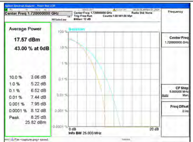
B4 / 20MHz / Low CH / 64QAM
