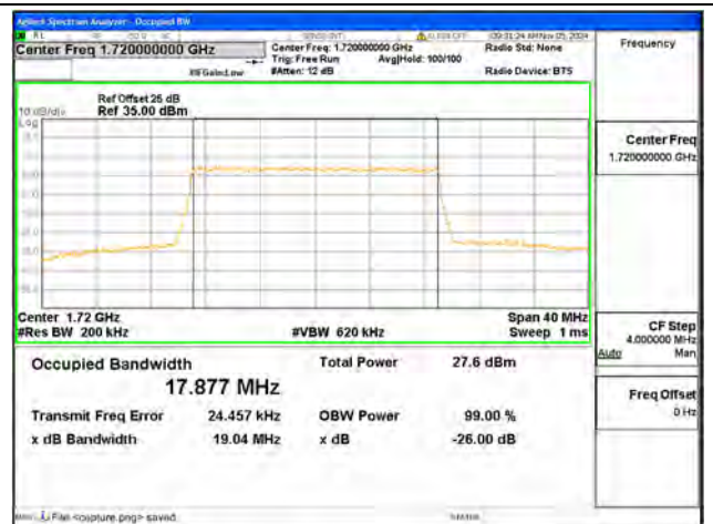
B66 / 20MHz / 64QAM/ Low CH
