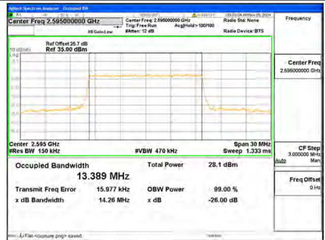
B38 / 15MHz / QPSK/ Mid CH
