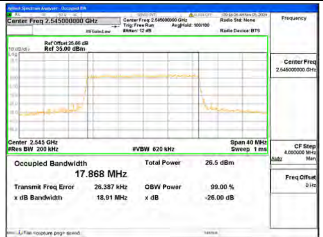
B41 / 20MHz / 64QAM/ Low CH
