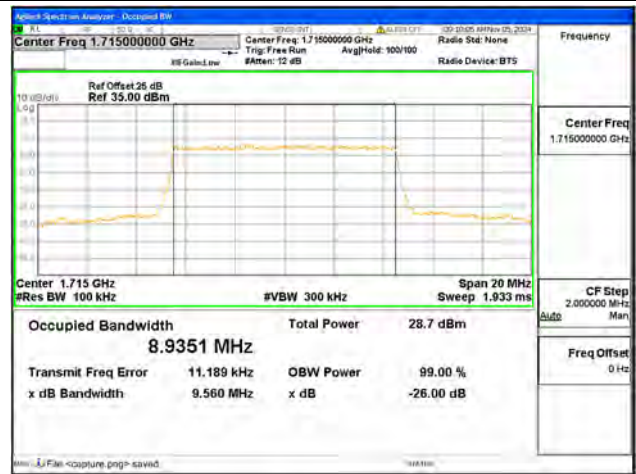
B4 / 10MHz / QPSK/ Low CH
