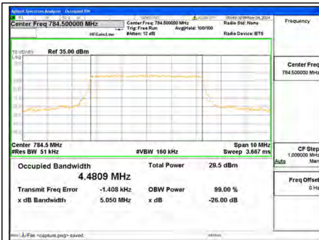
B13 / 5MHz / QPSK/ High CH
