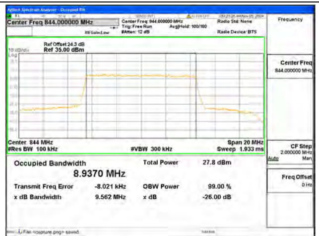
B5 / 10MHz / 64QAM/ High CH
