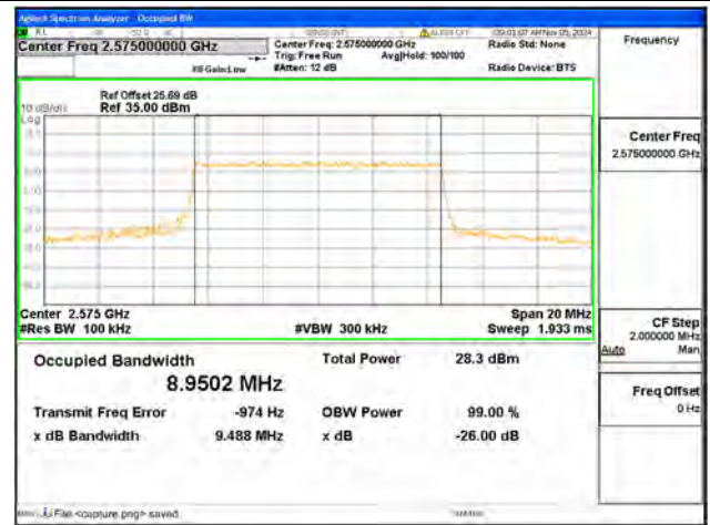
B38 / 10MHz / QPSK/ Low CH
