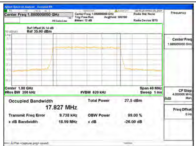
B2 / 20MHz / 16QAM/ Mid CH
