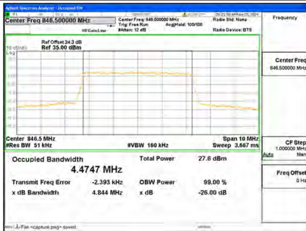
B5 / 5MHz / 64QAM/ High CH
