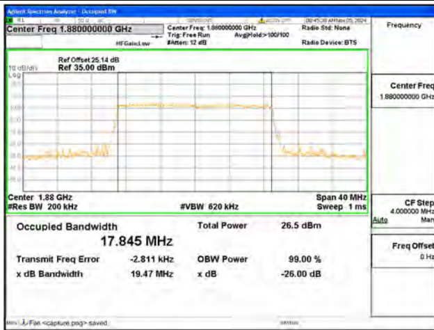
B2 / 20MHz / 64QAM/ Mid CH
