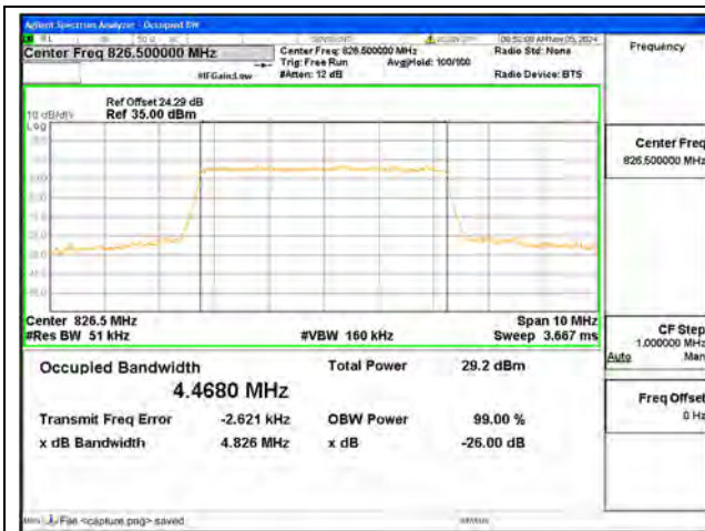
B26 / 5MHz / QPSK/ Low CH
