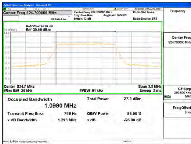
B5 / 1.4MHz / 64QAM/ Low CH
