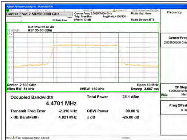
B7 / 5MHz / QPSK/ Low CH
