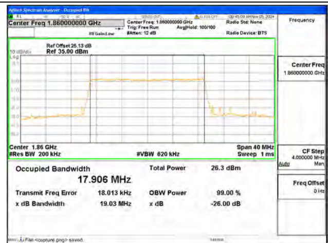
B2 / 20MHz / 64QAM/ Low CH
