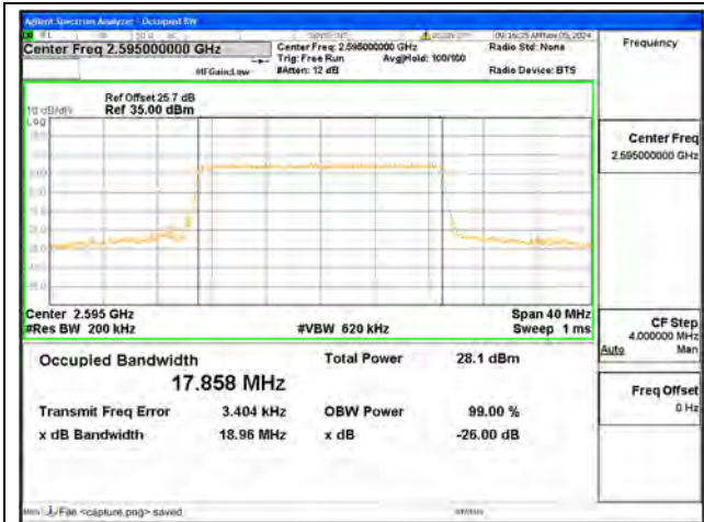
B41 / 20MHz / QPSK/ Mid CH
