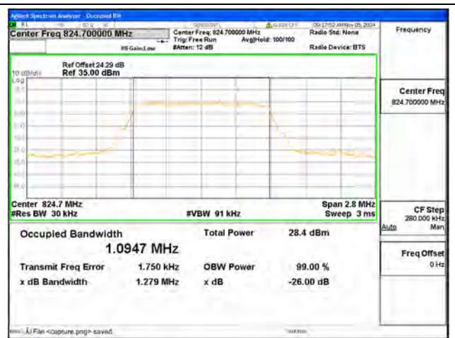
B5 / 1.4MHz / 16QAM/ Low CH
