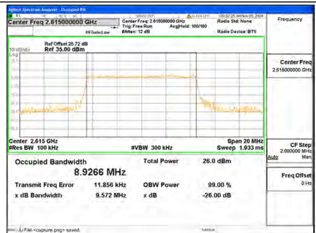
B38 / 10MHz / 64QAM / High CH
