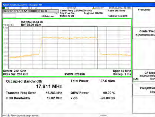
B7 / 20MHz / 16QAM/ Low CH
