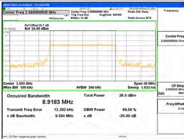
B41 / 10MHz / 64QAM/ Mid CH
