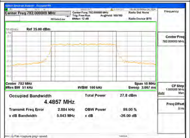
B13 / 5MHz / 64QAM / Mid CH
