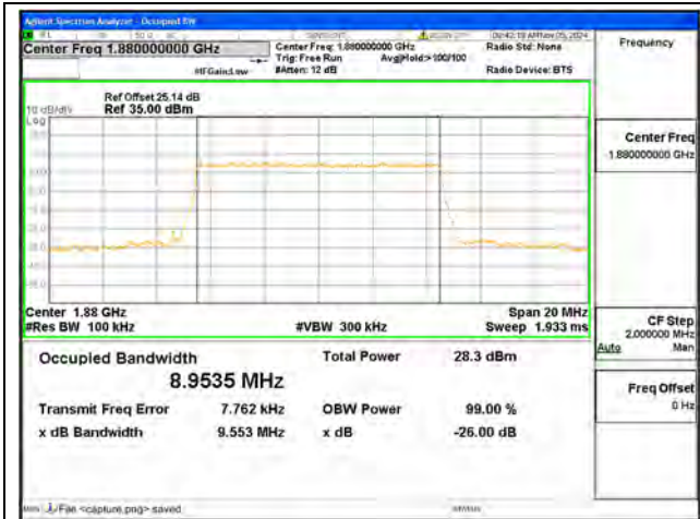
B2 / 10MHz / QPSK/ Mid CH
