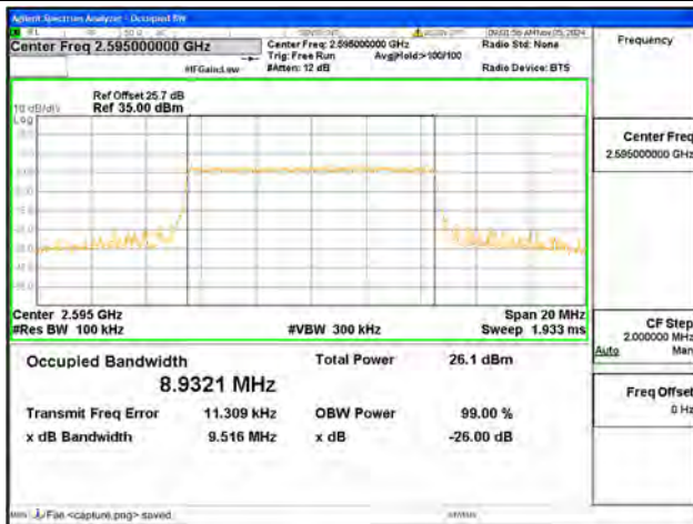
B38 / 10MHz / 64QAM / Mid CH
