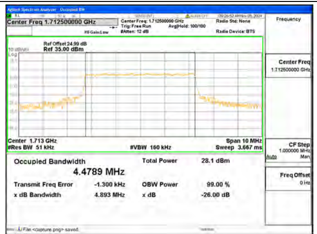
B66 / 5MHz / 16QAM/ Low CH
