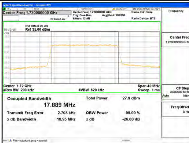
B4 / 20MHz / 16QAM / Low CH
