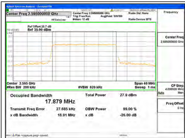
B38 / 20MHz / QPSK / Mid CH
