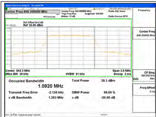
B5 / 1.4MHz / QPSK/ High CH
