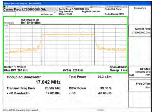
B66 / 20MHz / QPSK/ Low CH
