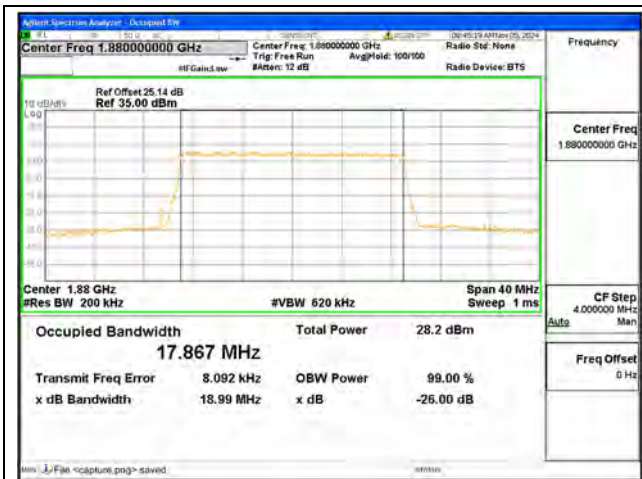
B2 / 20MHz / QPSK/ Mid CH
