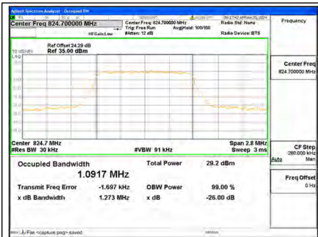
B5 / 1.4MHz / QPSK/ Low CH
