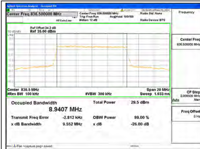
B26 / 10MHz / QPSK/ Mid CH
