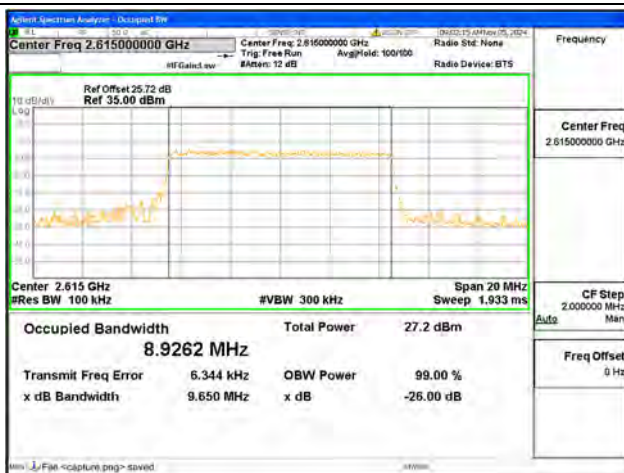
B38 / 10MHz / 16QAM / High CH
