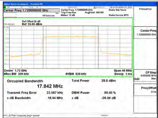
B4 / 20MHz / QPSK / Low CH
