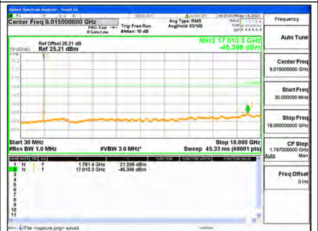
Band66 / 20MHz / High CH / QPSK
