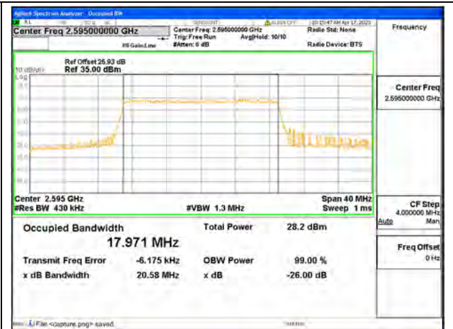
Band41(2535-2655) / 20MHz / 16QAM/ Mid CH
