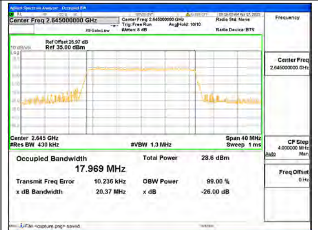
Band41(2535-2655) / 20MHz / QPSK/ High CH
