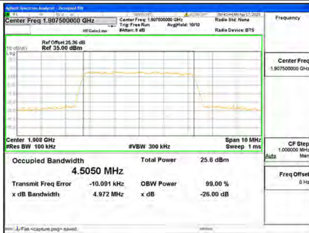
Band2 / 5MHz / 64QAM / High CH
