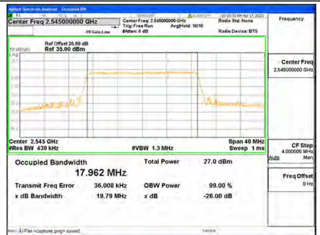
Band41(2535-2655) / 20MHz / 64QAM / Low CH
