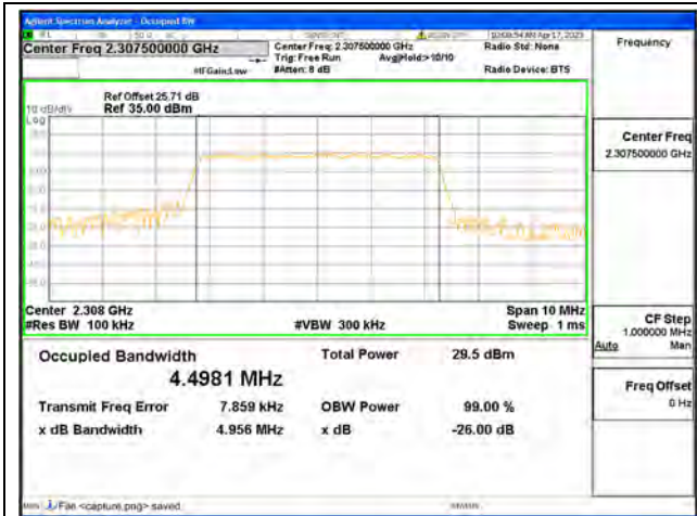
Band40-1 / 5MHz / QPSK/ Low CH
