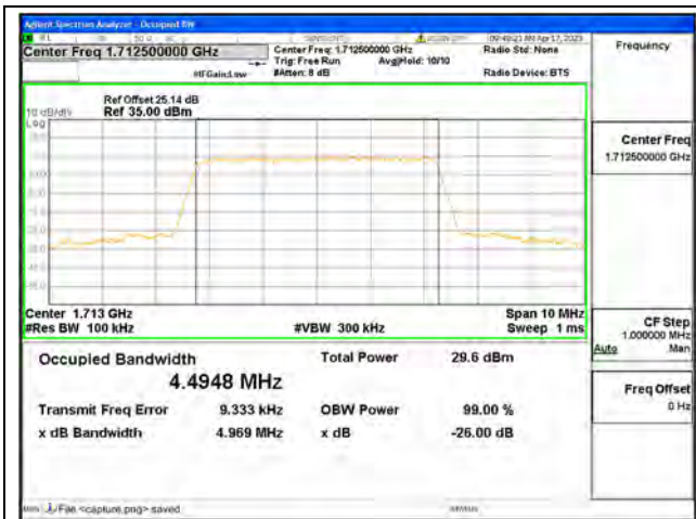
Band4 / 5MHz / QPSK/ Low CH
