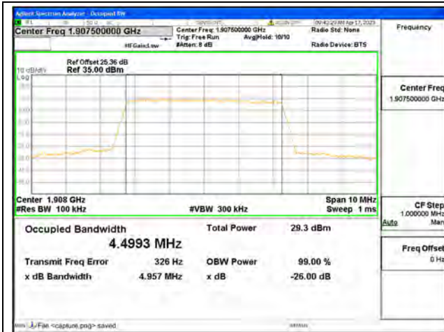
Band2 / 5MHz / QPSK / High CH
