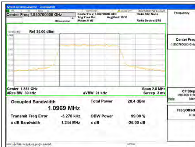
Band2 / 1.4MHz / QPSK/ Low CH
