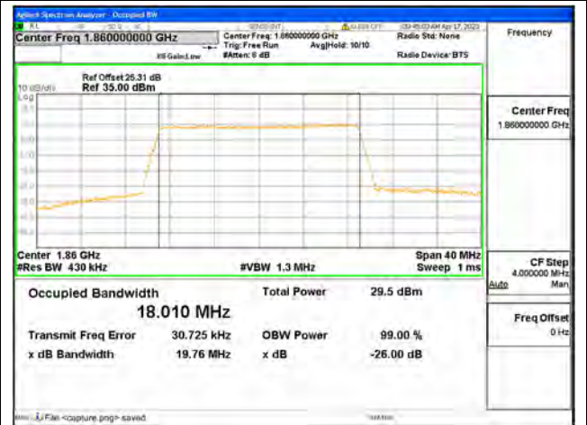
Band2 / 20MHz / QPSK/ Low CH
