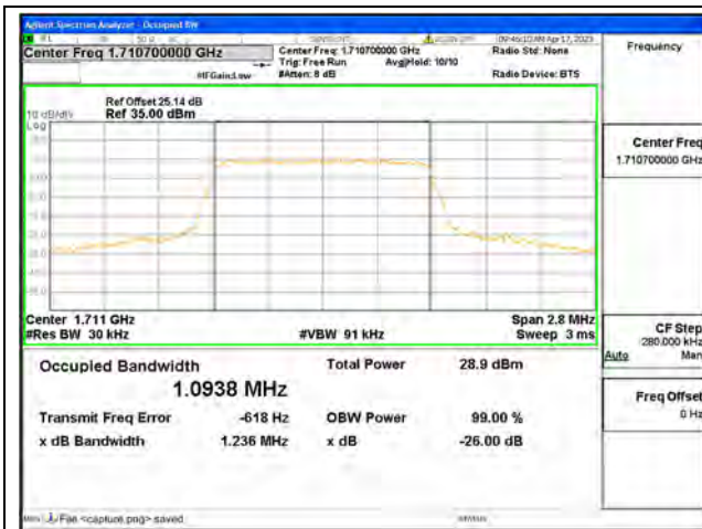
Band4 / 1.4MHz / QPSK/ Low CH
