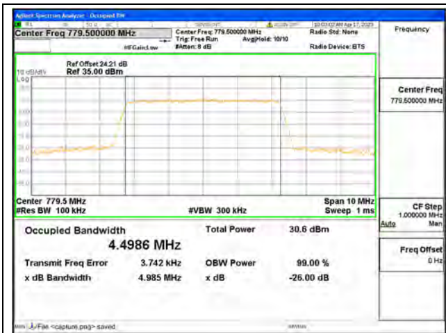
Band13 / 5MHz / QPSK/ Low CH
