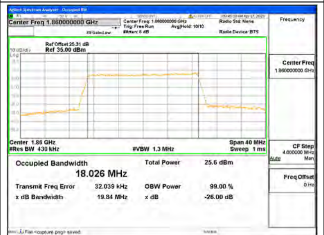
Band2 / 20MHz / 64QAM/ Low CH
