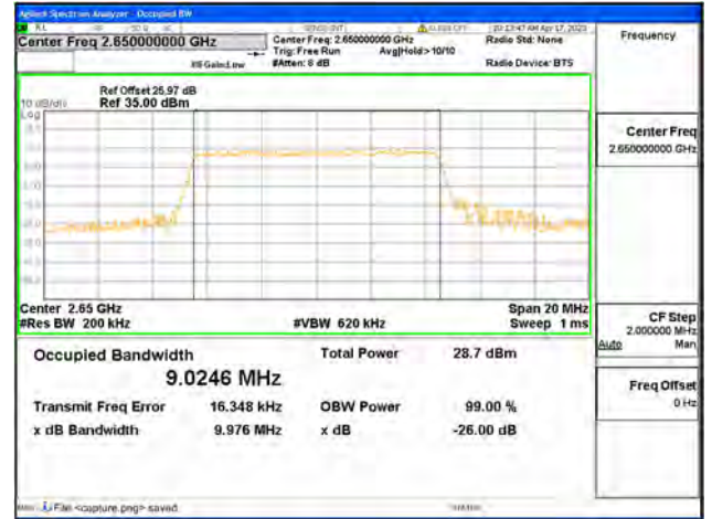
Band41(2535-2655) / 10MHz / QPSK/ High CH
