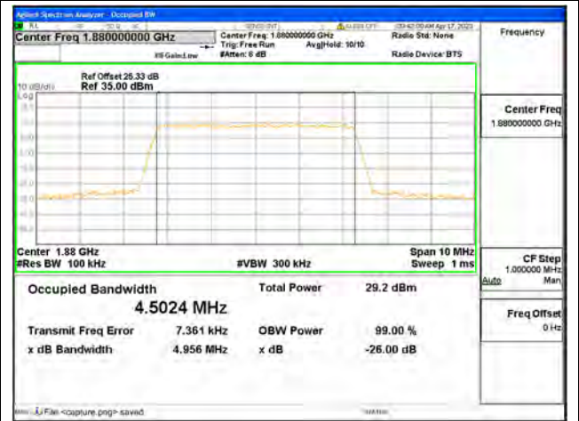
Band2 / 5MHz / QPSK/ Mid CH
