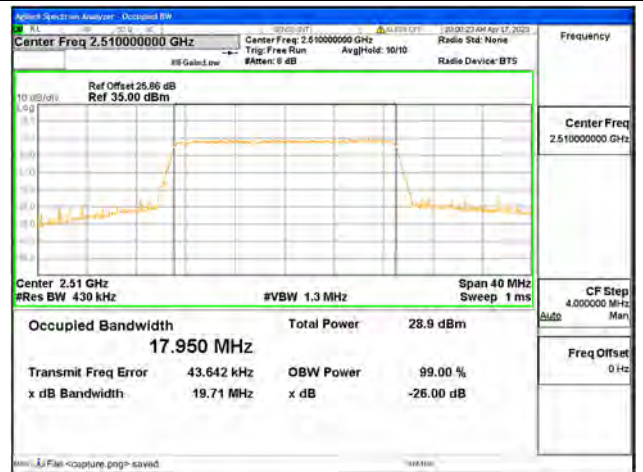
Band7 / 20MHz / QPSK/ Low CH
