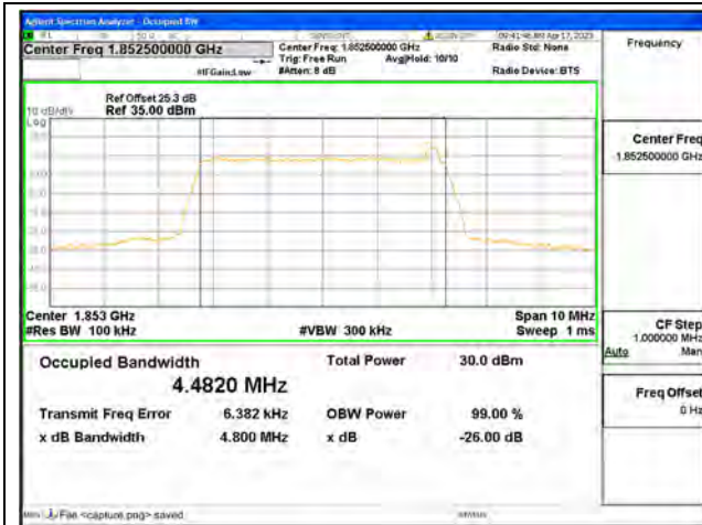
Band2 / 5MHz / QPSK/ Low CH
