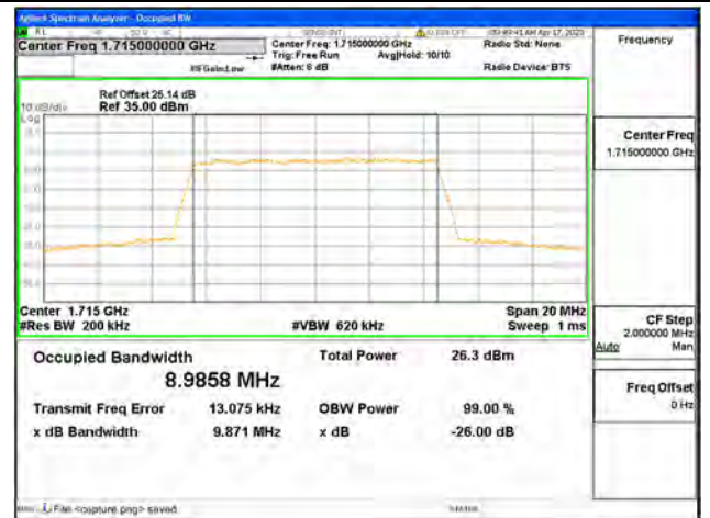
Band4 / 10MHz / 64QAM / Low CH
