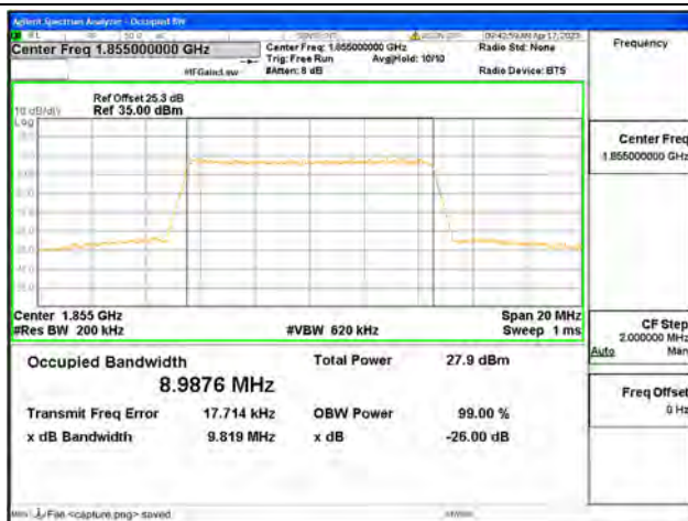
Band2 / 10MHz / 16QAM / Low CH
