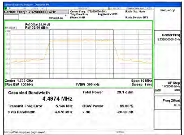
Band4 / 5MHz / QPSK/ Mid CH
